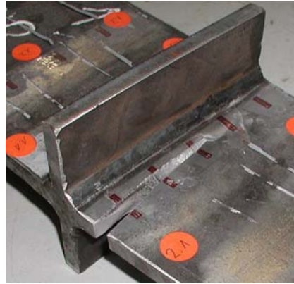
Bild 7: Ermüdungsversagen im Grundmaterial
