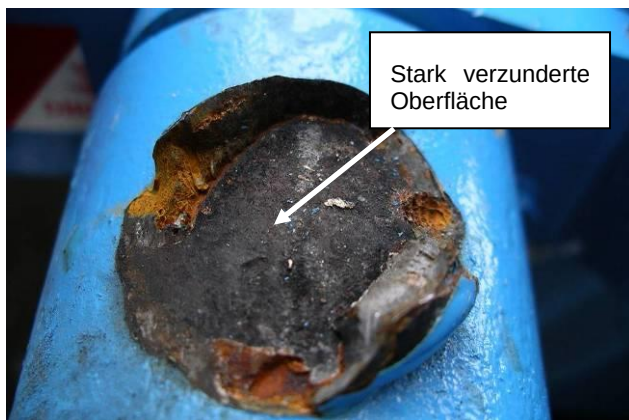
Bild 20: Schweißnaht am Zylinderauge
