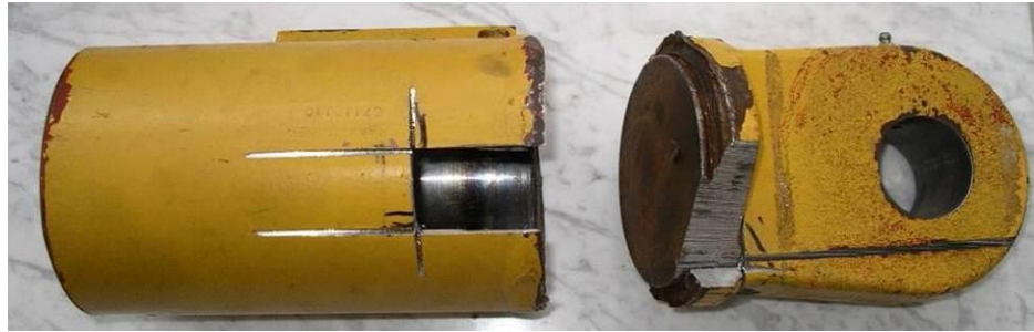
Bild 4 und 5: abgeknickter Ausleger mit abgerissenem Zylinderauge
