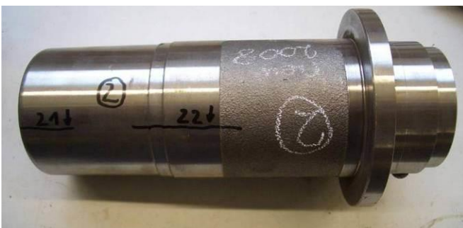
Bild 42: Führungsbuchse - weißer Temperguss
