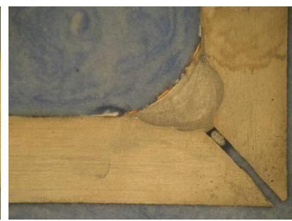
Bild 13: nicht durchgeschweißte Nähte
