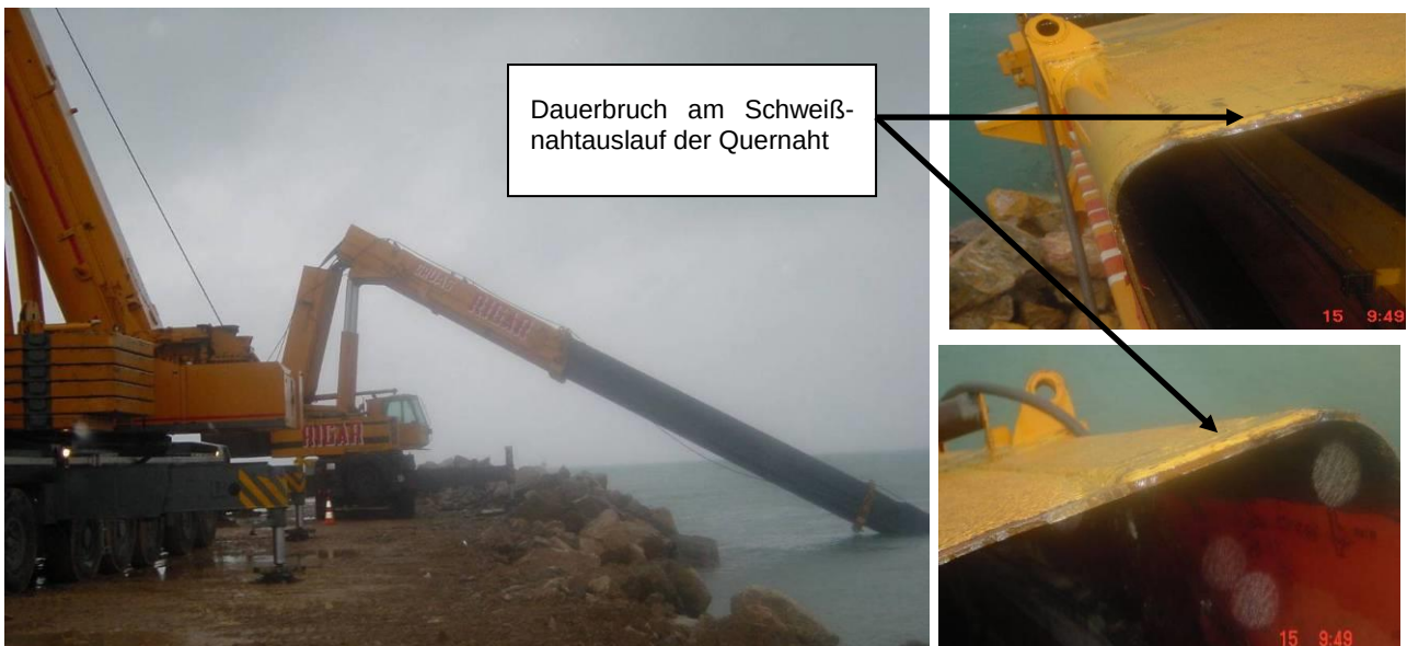
Bild 22: abgebr. Ausleger mit Dauerbrüchen an den Enden der Versteifungsbleche
