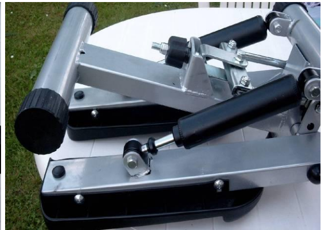
Bild 28: fast ausgerissener Haltewinkel
