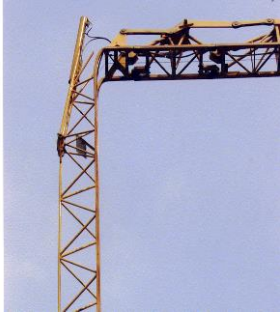
Bild 4 und 5: abgeknickter Ausleger mit abgerissenem Zylinderauge
