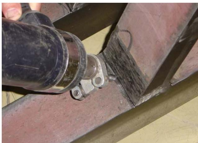
**Bild 8.** UIT-Behandlung des Prüfkörpers
