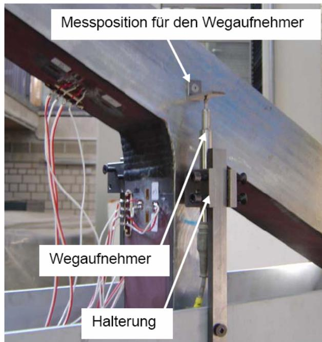
**Bild 9.** Messtechn. Vorbereitungen am Prüfkörper
