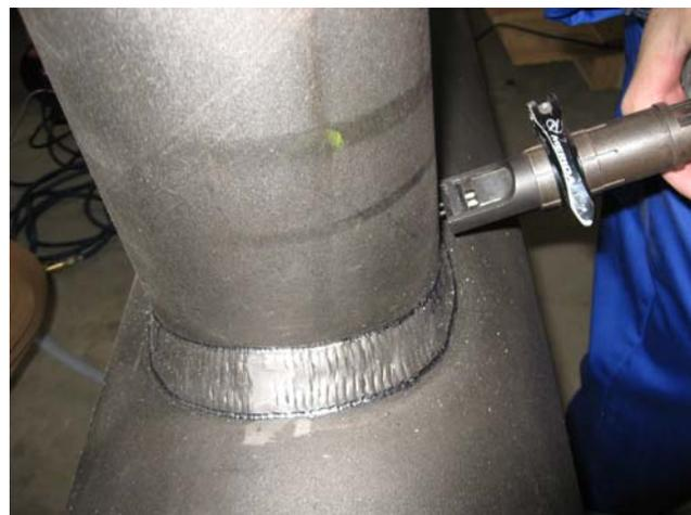
**Bild 2.** UIT-Behandlung an einem Rohrprobekörper
