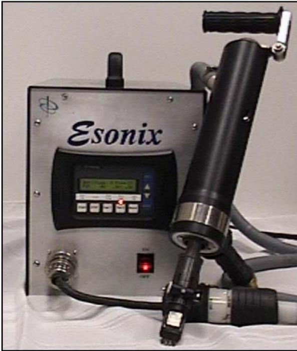
**Bild 3.** US-Generator mit Handgerät
