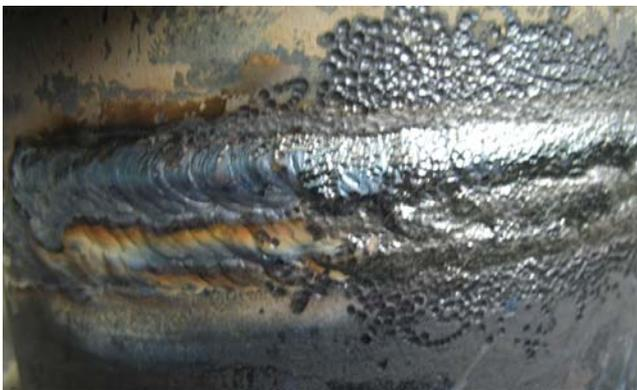
**Bild 15.** Komplette Naht mit Wärmeeinflusszone wird UIT behandelt
