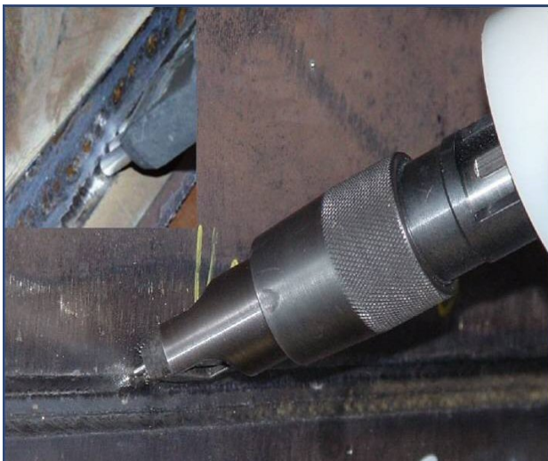
Bild 4. Behandlung einer Schweißnaht
