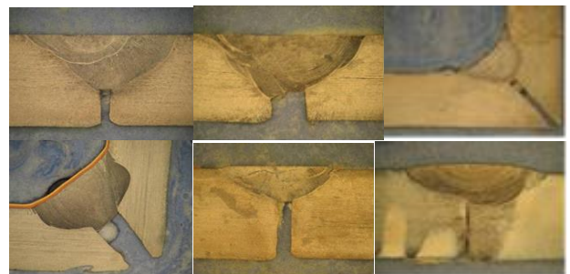
Bild 14: Schliffbilder aus verschiedenen Positionen
