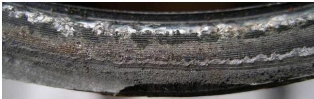
Bild 8: Drehriefen auf Schweißnaht abgebildet
