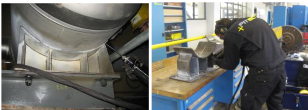
Bild 23: PIT Behandlung der Nahtübergänge
