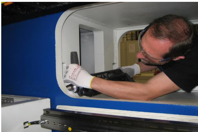
Bild 13: PIT Behandlung eines „Hotspots“
