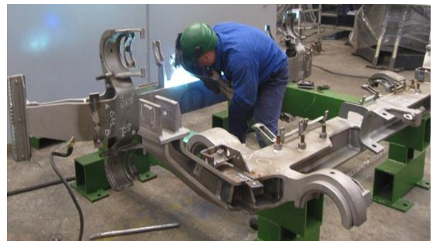
Bild 9: Reparaturschweißen gem. Schweißanweisung
