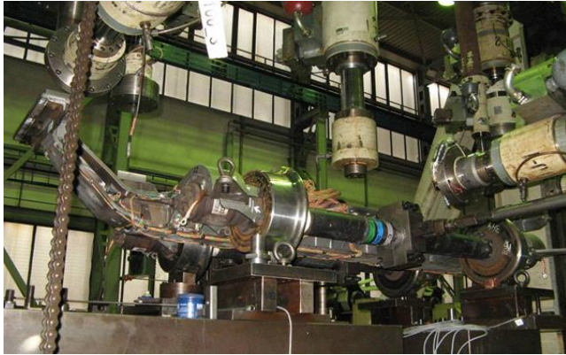
Bild 12: komplettes Aggregat auf Schwingungsprüfstand
