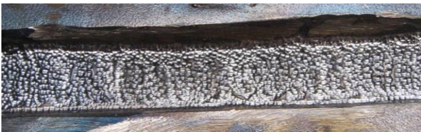
Bild 11: PIT behandelte Zwischenlage
