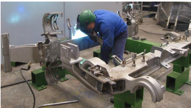
Bild 9: Reparaturschweißen gemäß Schweißanweisung
