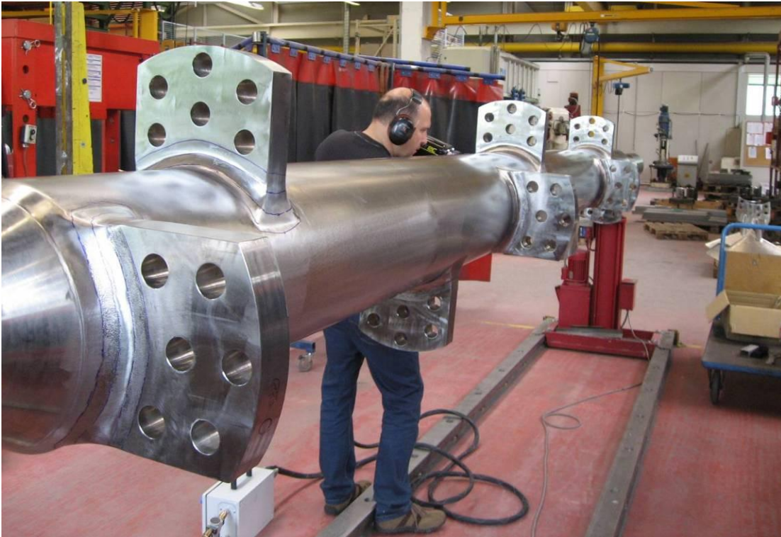
Bild 19 - Rührwerkswelle ca. 8 m lang und ca. 300 mm Durchmesser
