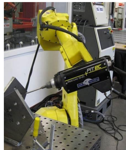
Bild 5 - PIT am Roboter
