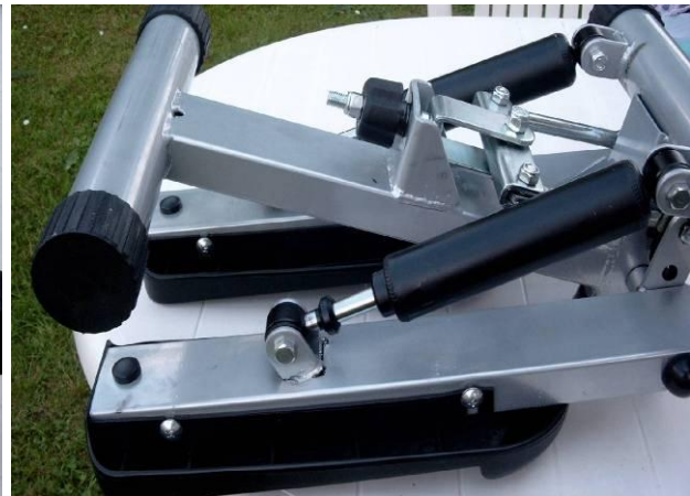
Bild 28: fast ausgerissener Haltewinkel
