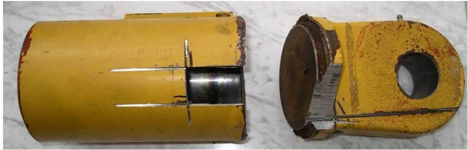
Bild 4 und 5: abgeknickter Ausleger mit abgerissenem Zylinderauge
