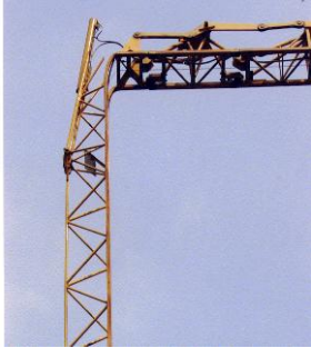
Bild 4 und 5: abgeknickter Ausleger mit abgerissenem Zylinderauge
