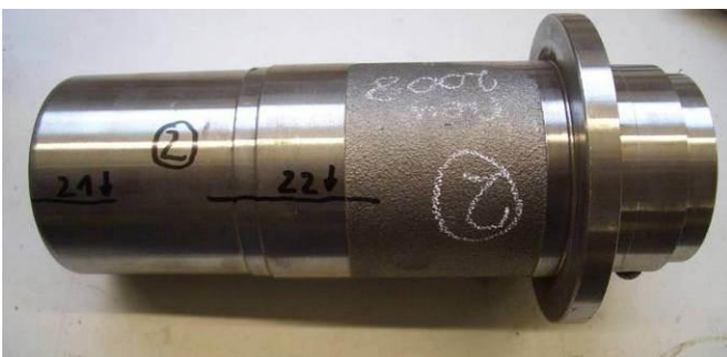
Bild 42: Führungsbuchse - weißer Temperguss
