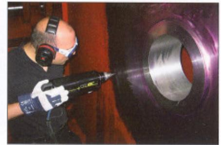
Bild 12. PIT-Behandlung eines eingeschweißten Lagers.
