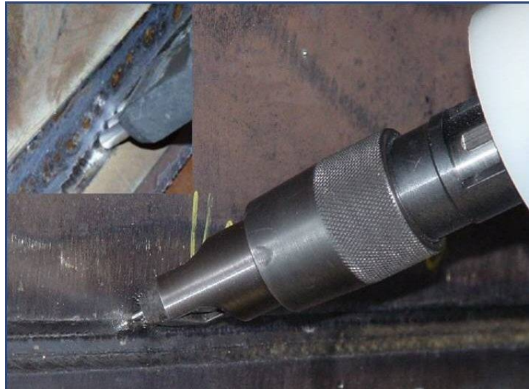
Bild 3: Behandlung einer Schweißnaht
