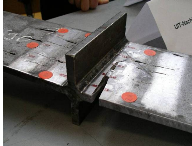
Bild 6: Bruch im Grundwerkstoff S690 UIT
