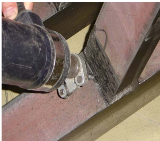
Bild 16: UIT-Behandlung der Probe
