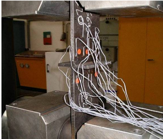
Bild 5: Probe mit Dehnmessstreifen
