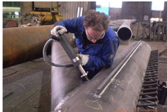
Bild 22: UIT Behandlung des Obergurtes
