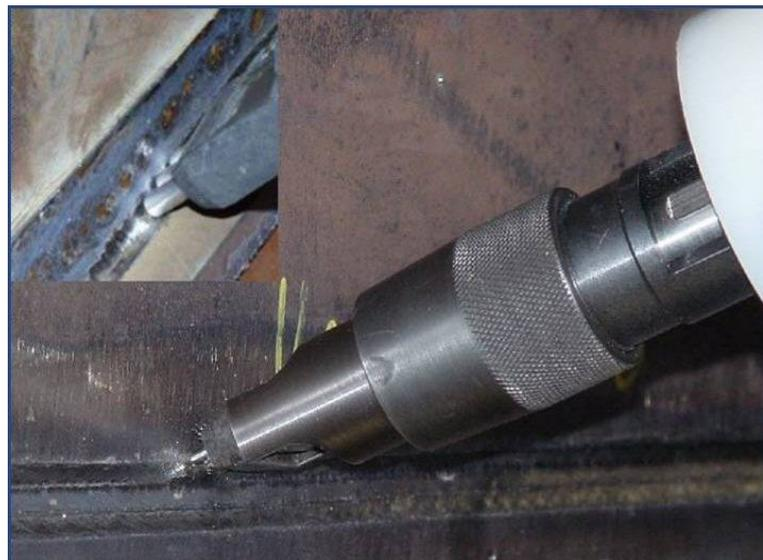
**Bild 3:** Behandlung einer Schweißnaht
