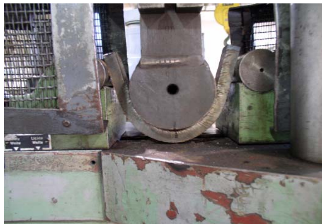
Bild 4: Probe beim Fallversuch
