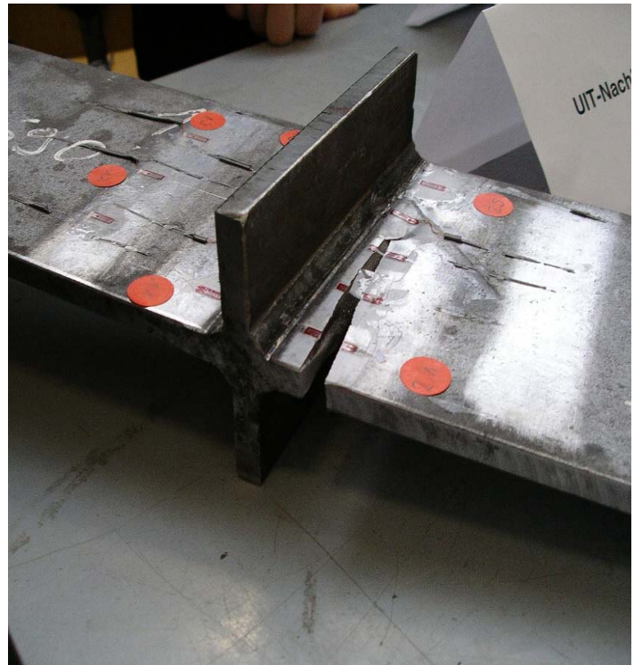
Abb. 6: Probe mit Dehnungsmessstreifen Abb. 7: Bruch im Grundwerkstoff S690 UIT
