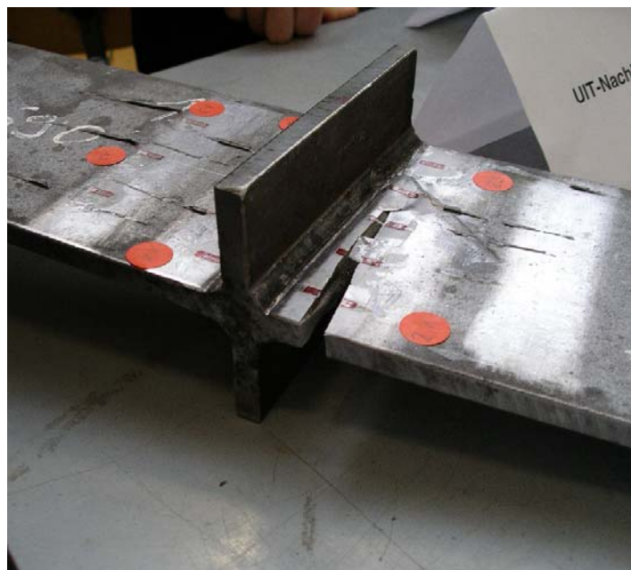
Bild 6: Bruch im Grundwerkstoff S690 UIT
