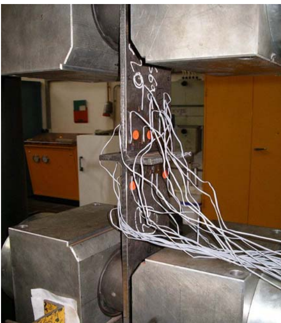
Bild 5: Probe mit Dehnungsmessstreifen
