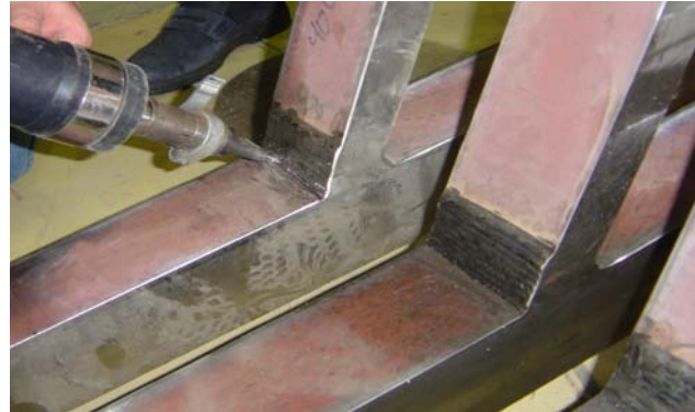
Bild 26: Probenbehandlung mit UIT
