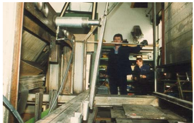
Bild 6. Belastungsprüfung mit 1000 daN
