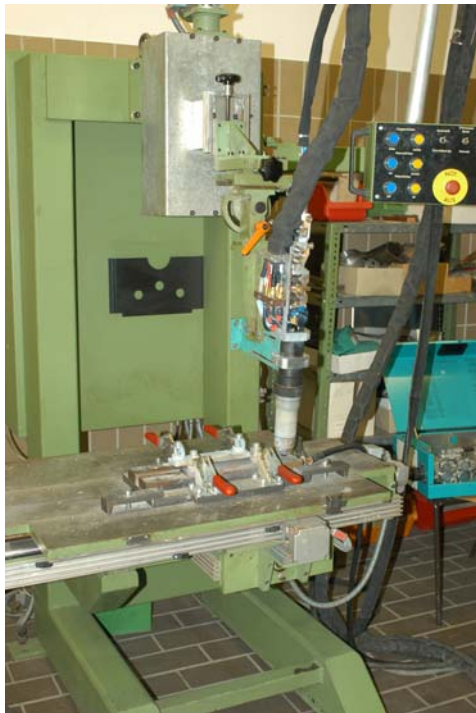
Bild 3 Schweißanlage der Fa.Merkle mit Brenner und Drahtvorschubeinheit
