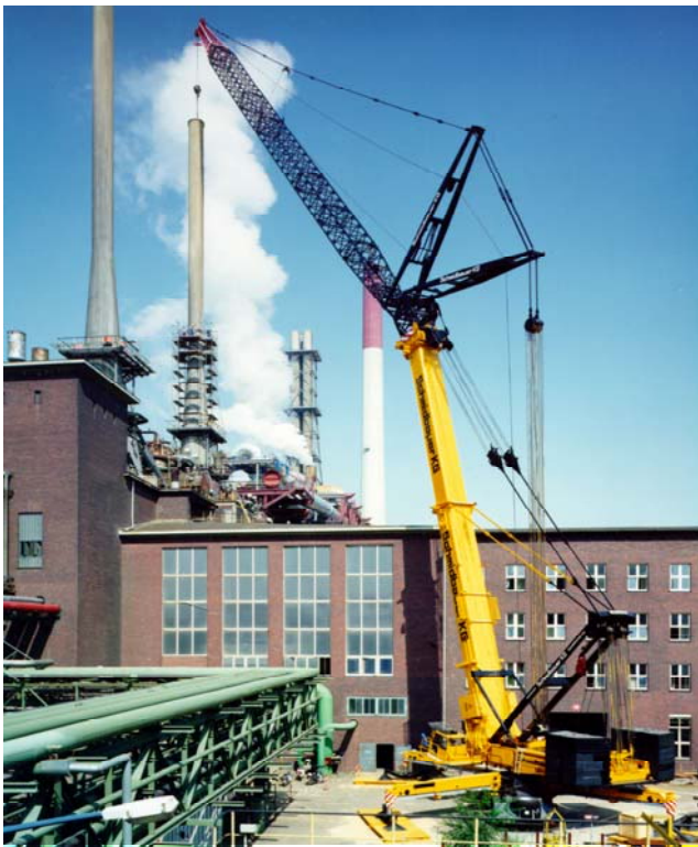
Bild 1. 800 t-Mobilkran aus XABO 960 (S960 QL), Hubhöhe 134 m, Gesamtgewicht ohne Ausleger 96 t
