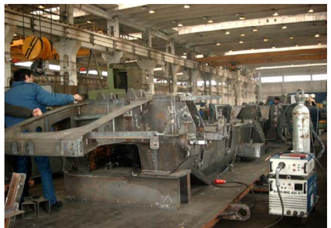
Bild 4. Fahrzeugrahmen aus S960QL für einen 80t-Mobilkran
