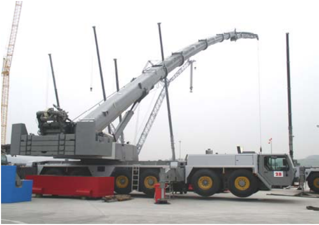
Bild 11. 250 t-Mobilkran mit max. 72 m Teleskopausleger und Klappspitze, Drehbühne, Fahrzeugrahmen, Abstützung aus XABO 890 / 960, Teleskopausleger aus XABO 1100
