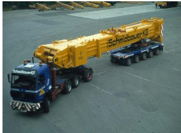
Bild 10 u. 11 zeigen einen Mobilkran mit 800 t Tragkraft im Transportzustand aus S960QL
