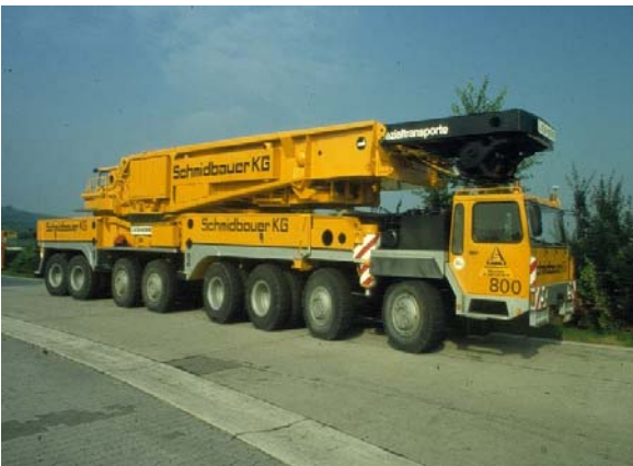
Bild 10 u. 11 zeigen einen Mobilkran mit 800 t Tragkraft im Transportzustand aus S960QL
