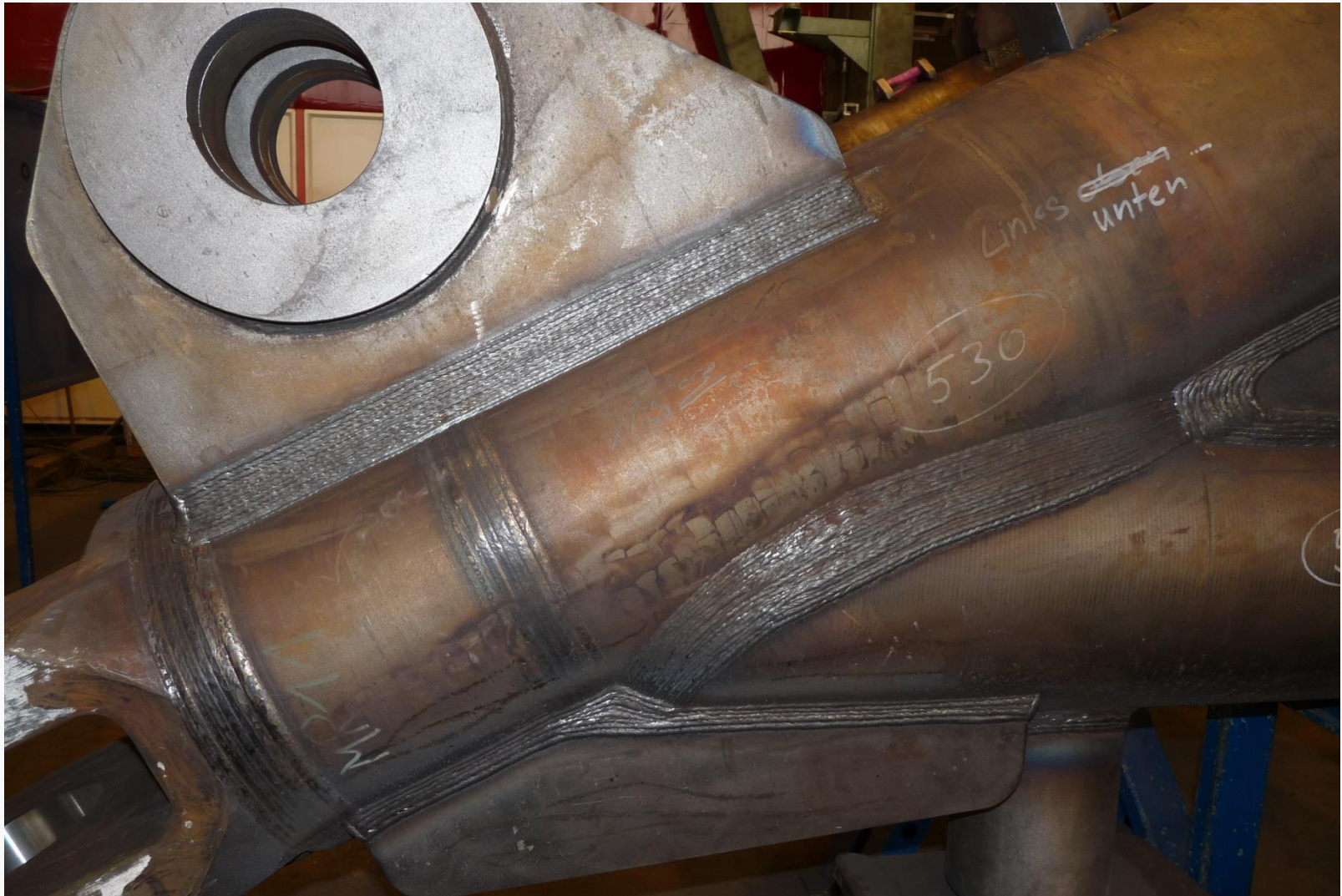
Rohrkonstruktion – Raupenkran LR 13 000
