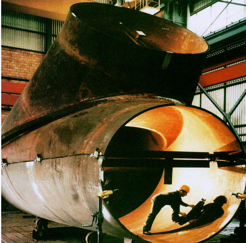
Hosenrohr aus XABO 960 für eine Druckrohrleitung
