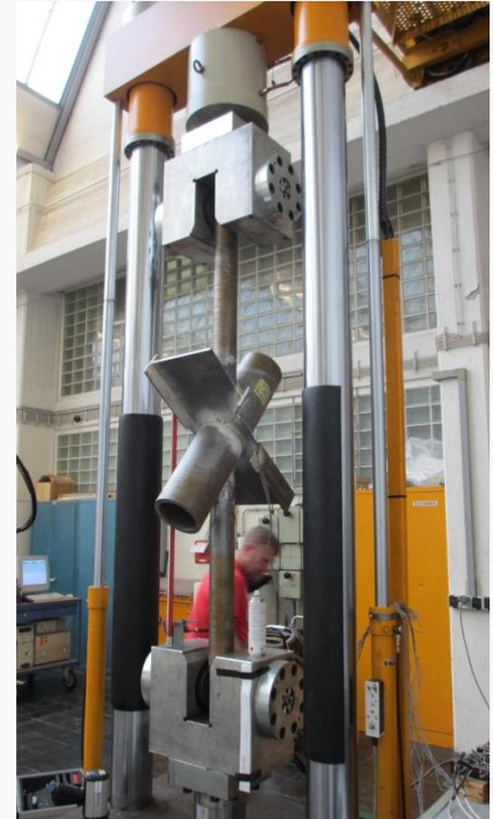
***Da die Fahrbahn der Cable Cars über Straßen und Autobahnen führt, hat Amerika schärfere Anforderungen an die Ermüdungsfestigkeit gestellt. Ohne konstruktive Änderungen konnte mit Hilfe der PIT Behandlung eine Steigerung der Lebensdauer um das 4,5 fache erzielt werden. Diese guten Ergebnisse wurden sowohl an der Universität Stuttgart, als auch an der Uni in Seattle(WA) ermittelt***
