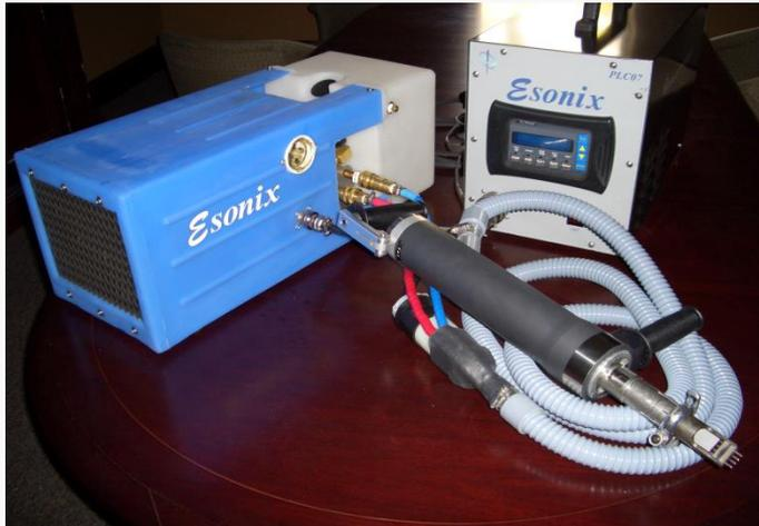
a) UIT-Gerät der Fa. Applied Ultrasonics
