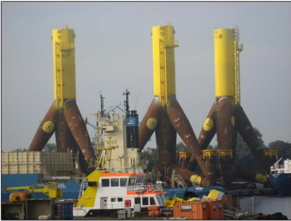
Bild 7: Beispiel einer Gründungsstruktur für Unterwassereinsatz
