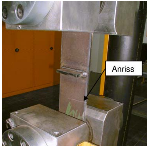
Bild 6: Ermüdungsversagen im Grundmaterial
