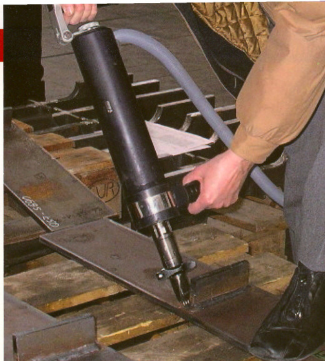
Abb. 2: UIT-Behandlung der Proben
