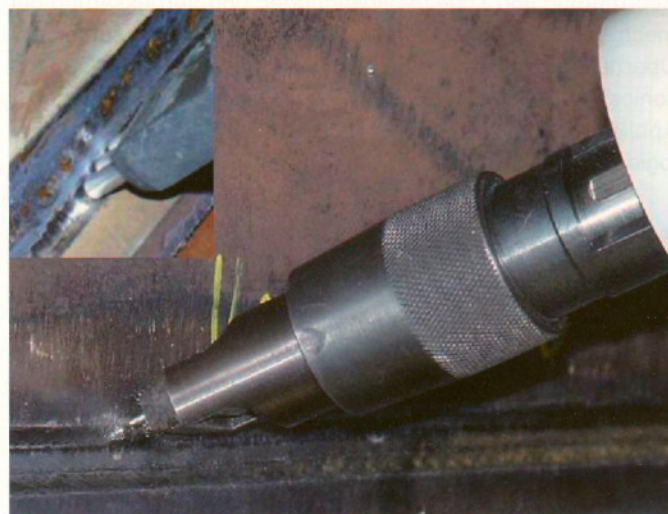
Abb. 4: Behandlung einer Schweissnaht
