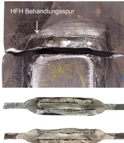
Bild 8. Bruchbilder und -flächen von zwei HFH-behandelten Versuchskörper des Kerbdetails Lamelle
