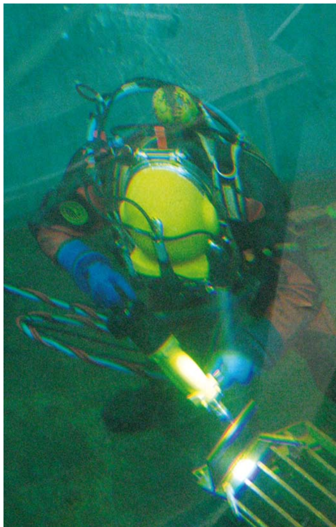
Behandlung eines Probestückes mit einem PIT-Unterwassergerät
