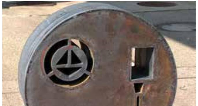
Abb. 2: Feinere Innenkonturen und auch Aussenkonturen sind das Ergebnis der kombinierten OmniMat® L 6500. Zudem reduziert sich der Bauteilabstand und das Blech bleibt geschlossen.
