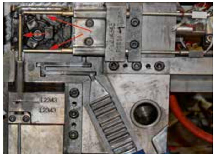
*Der Länge nach durchbohrte Stifte mit eingesetzten Röhrchen (Pfeile) ermöglichen die effiziente Kühlung kritischer Formpartien (Foto: Klaus Vollrath)*
