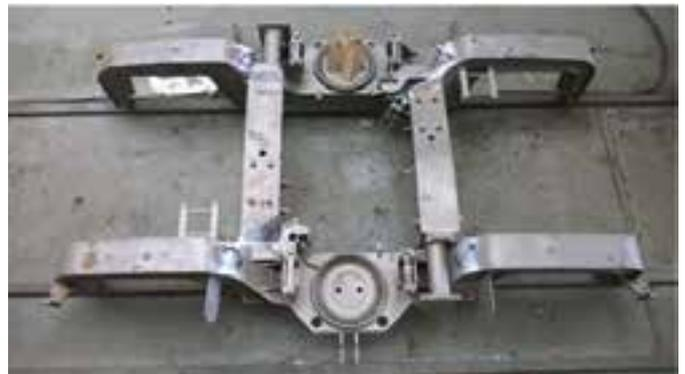
Abb. 16: Drehgestell einer Strassenbahn (IFTEC)
