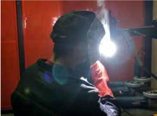
Abb. 7: Elektrodenhandschweissung in Position
