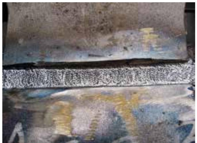
Abb. 11: PIT behandelte Zwischenlage
