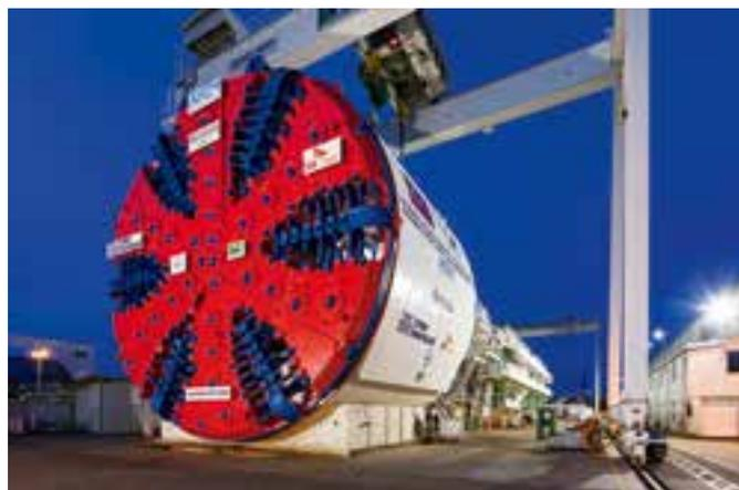
Die Herrenknecht TBM S-762 vom Typ Mixschild (Ø 13,66 m) wurde im Werk der Herrenknecht AG in Deutschland montiert und ausgiebig getestet. Zu den technischen Neuerungen zählt ein begehbare Schneidrad für den sicheren Wechsel der Abbauwerkzeuge unter atmosphärischen Bedingungen. Spezielle Schleusensysteme ermöglichen den Einsatz bei bis zu 11 Bar Umgebungsdruck.
