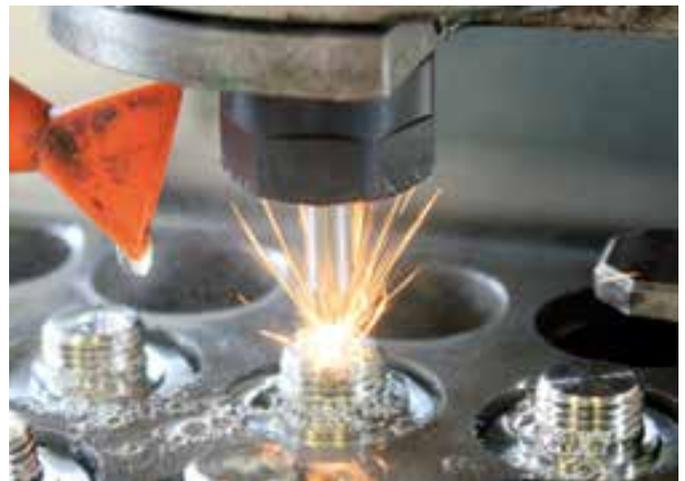
*Beim Erodierbohren erfolgt der Materialabtrag berührungslos durch kurze Spannungsimpulse, die zu Funkenüberschlägen führen (Foto: Klaus Vollrath)*
