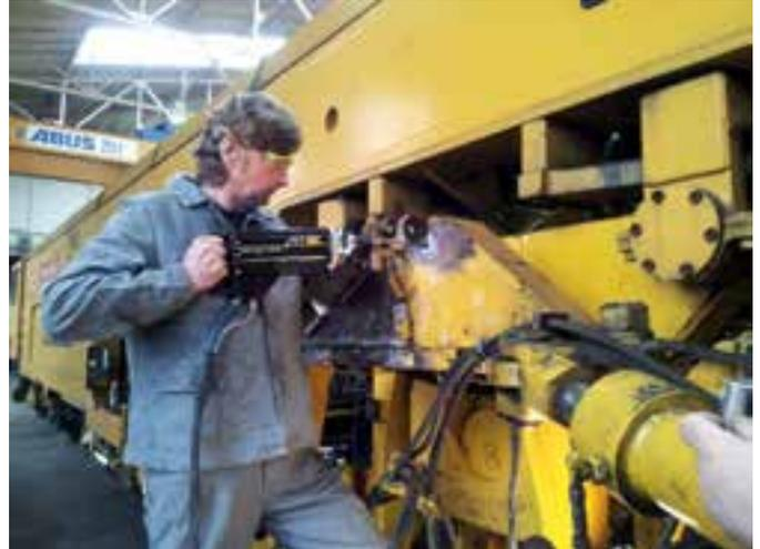
Abb. Bild 15: PIT Behandlung kritischer Anbauteile (GBM)
