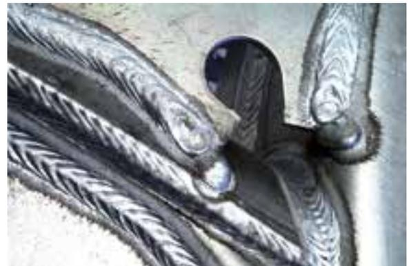
Abb. 1: Heliumeinfluss bei MIG-Aluminium-Schweißen
