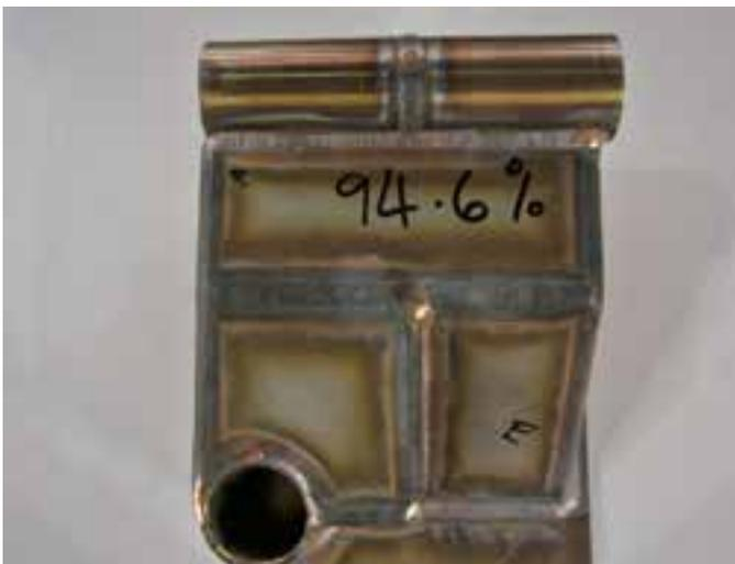
Abb. 9: TIG-Schweissen der Cr-Ni-Konstruktion 94,6 % durchgeschweisste Nähte, das kann sich sehen lassen!
