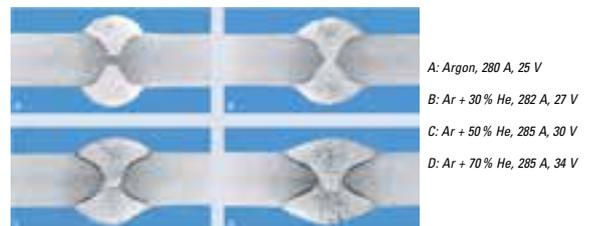
Abb. 2: Heliumeinfluss beim MIG-Aluminium-Schweißen
