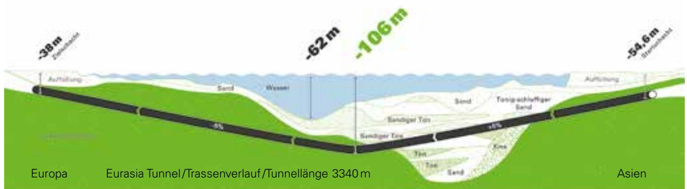
atischen Seite am süd-östlichen Ende des Bosphorus los. Bei einem Gefälle von fünf Prozent tunnelte sich der grossformatige Mixschild bis zum tiefsten Punkt 106 Meter unter dem Bosphorus. Dort herrschen 11 Bar Wasserdruck. Kombiniert mit einem sehr wechselhaften, verschleissintensiven Untergrund stellt das für die Abbauwerkzeuge des riesigen Schneidrades eine Extrem-Anforderung dar.
