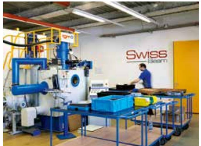
Abb. 9: Eine von zwei Elektronenstrahlschweissanlagen bei SwissBeam
