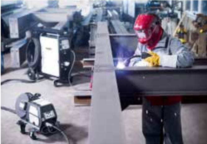
Abb. 1: Kosten senken, der nahezu spritzerfreie «forceArc puls»-Lichtbogen minimiert die Nacharbeit. Foto: EWM AG
