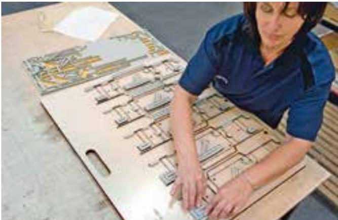
Die hochpräzise mit dem Wasserstrahl geschnittenen Gummimatten drücken das Schnittgut nach dem Schnitt wieder aus den Zwischenräumen zwischen den Messerleisten heraus, so dass es nicht hängenbleibt (Foto: ImaPack)
