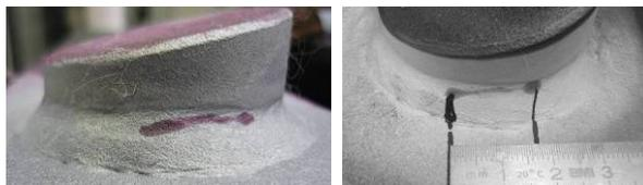
**Abbildung 6: Rissbild eines unbehandelten Versuchskörpers**
