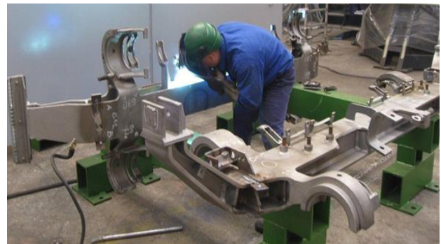
Bild 9: Reparaturschweißen gem. Schweißanweisung
