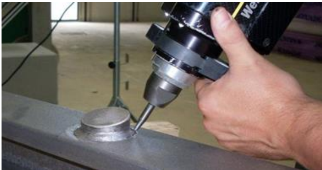
Bild 18: PIT-Behandlung des Nahtübergangs
