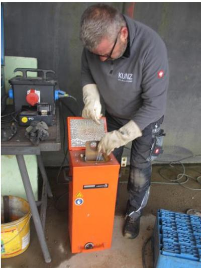
**Bild 18:** Elektrodentrockenofen
