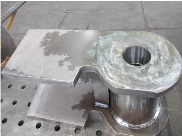
**Bild 12:** neugefertigte Untergruppe aus S355
