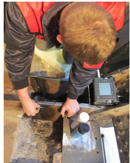
**Bild 23:** Ultraschall-Prüfung
