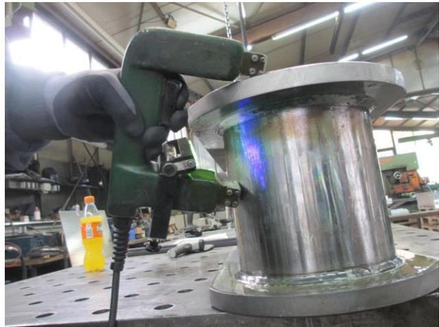
**Bild 13:** MT-Prüfung der Untergruppe
