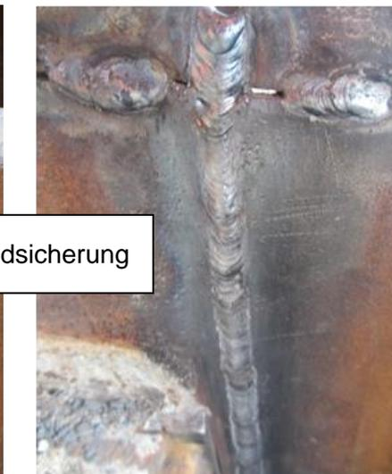
**Bild 22:** fertige Wurzel
